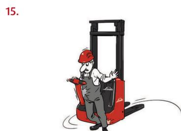
15. Bei seitlicher Deichselposition ist die Einklemmgefahr zwischen Deichsel/Fahrzeug und Regal besonders groß. Immer Sicherheitsabstand halten und die Geschwindigkeit der Situation anpassen.
