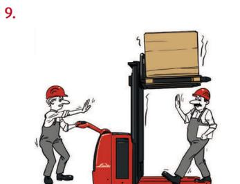
9. Nicht unter die Last treten. Gefahr durch herabfallende Last oder durch Absenken des Gabelträgers. Zusätzliche Stolpergefahr besteht beim Überschreiten der Radarme.
