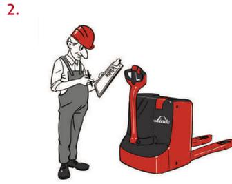
2. Vor Arbeitsbeginn ist die tägliche Einsatzprüfung durchzuführen. Fahren, Heben, Lenken, Bremsen und Noteinrichtungen müssen funktionieren. Schäden am Fahrzeug sind sofort meldepflichtig!
