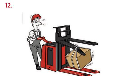
12. Sichere Lastaufnahme: Die Tragfähigkeit des Fahrzeugs darf nicht überschritten werden. Die Gabelzinken nicht einseitig belasten. Nur gesicherte Lasten transportieren.
