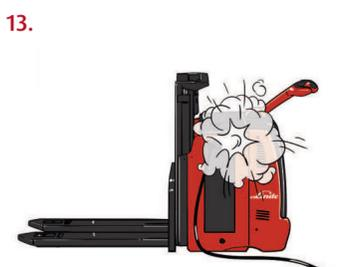
13. Beim Batterieladen entsteht explosives Knallgas. Deshalb: Jegliche Funkenbildung vermeiden und zur Belüftung die Haube des Batterieraums öffnen. Die Batterien müssen gemäß Herstellerangaben gewartet werden.
