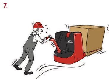
7. Bei längeren Strecken: Fahrzeug in Richtung der Deichsel (Fahrtrichtung vorwärts) bedienen. Bei Lastaufnahme/-absetzen und beim Bergauffahren mit Last: Bedienung in Richtung der Gabelzinken (Fahrtrichtung rückwärts).
