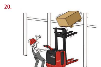
20. Lasten immer ordnungsgemäß ins Regalfach stellen. Beschädigte Ladeeinheiten dürfen nicht gelagert oder transportiert werden. Lose Teile und ungesicherte Ladung dürfen nicht transportiert werden.
