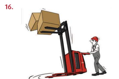
16. Die Standsicherheit ist nicht garantiert bei: zu schneller Kurvenfahrt. Fahren mit angehobener Last. Fahren mit zu schwerer, zu breiter, pendelnder oder zur Seite ausgeschobener Last.
