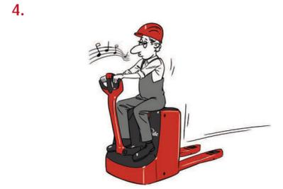
4. Mitfahren ist ausnahmslos verboten. Das Fahrzeug muss gemäß der Betriebsanleitung bedient werden.
