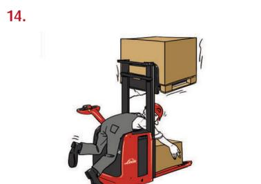
14. Nicht durch den Hubmast beugen oder greifen. Fehlende oder defekte Durchgreifsicherungen sind sofort zu ersetzen.
